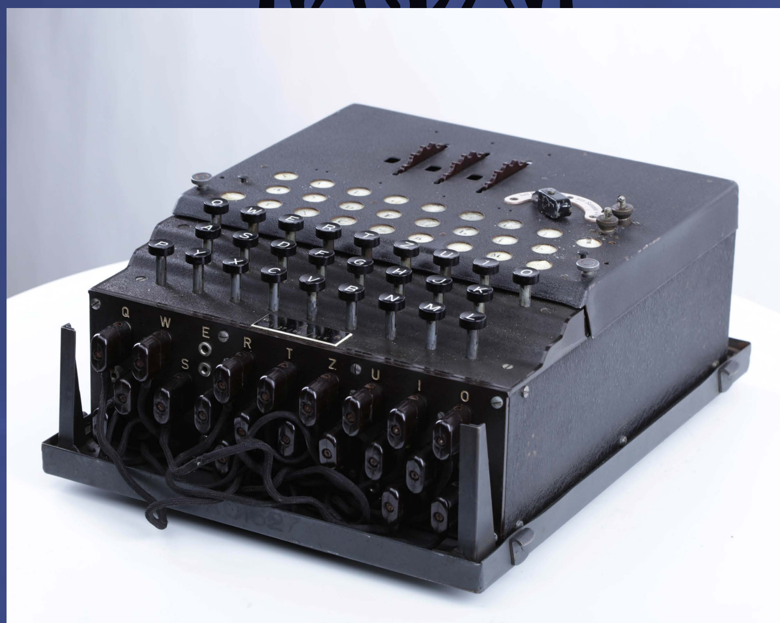
Niemiecka maszyna szyfrująca Enigma. Widoczna klawiatura, panel i wystające przez pokrywę trzy karbowane pierścienie wirników. Fot. Narodowe Muzeum Techniki w Warszawie.
