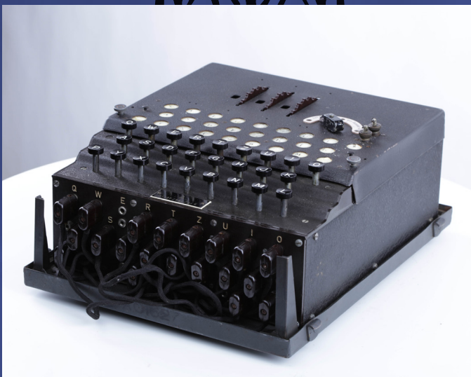
Niemiecka maszyna szyfrująca Enigma. Widoczna klawiatura, panel i wystające przez pokrywę trzy karbowane pierścienie wirników. Fot. Narodowe Muzeum Techniki w Warszawie.
